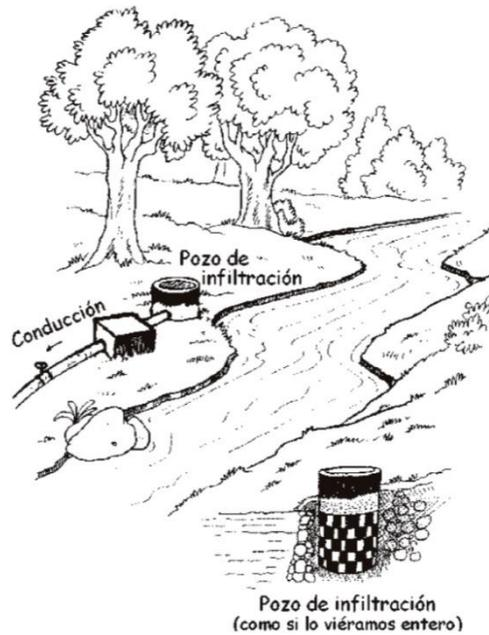
**Toma lateral:** Se construye en la orilla de los ríos, cuando son caudalosos y tienen poca variación de nivel. Una parte de la corriente de agua superficial es encauzada hacia un costado. Pueden ser muros laterales con rejillas y compuertas que impiden el paso de sólidos flotantes y permiten regular la entrada del agua al canal o tubería. El agua es recogida por un tubo o canal revestido y es conducida hacia un tanque recolector.
