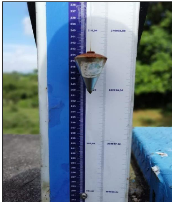
Imagen 17. Regleta Que Mide El Nivel Del Tanque De Almacenamiento
